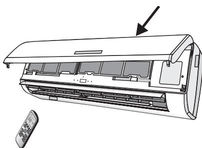
2. Регулирование направления потока воздуха в вертикальной плоскости [вверх-вниз]. Регулирование направления потока воздуха в вертикальной плоскости выполняется поворотом горизонтальных жалюзи с пульта дистанционного управления с помощью клавиши SWING.
