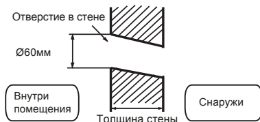
Стенное отверстие в разрезе
